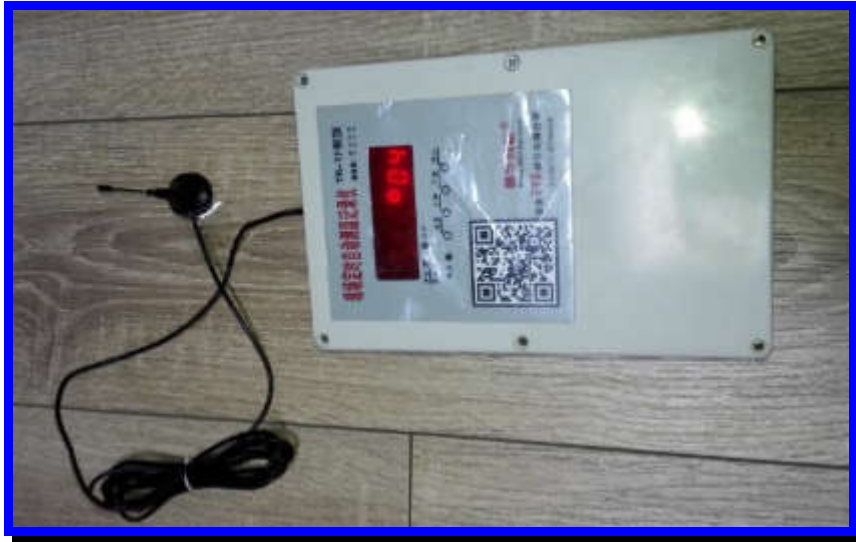
这是拧上 GSM 天线的样子（正好赶上设备定时自动启动了，看一数码管上有内容显示）
