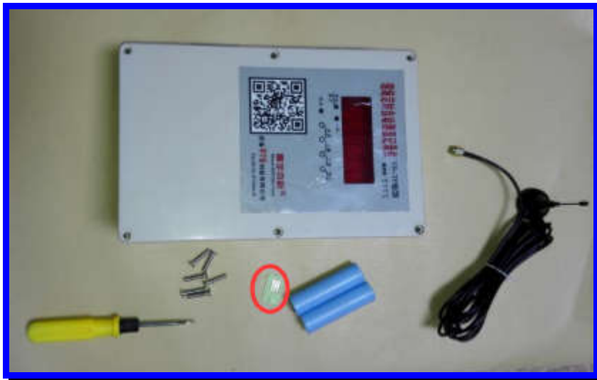
这个图，同时展示了设备内需要用到的物件：SIM 卡、2 节锂电池，GSM 天线。
